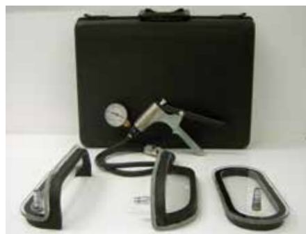
Våtrumskontroll var för att man hade ambitioner att göra stickprovskontroller på våtrumsobjekt. Vid dessa stickprovningar använde man bland annat den här utrustningen.
