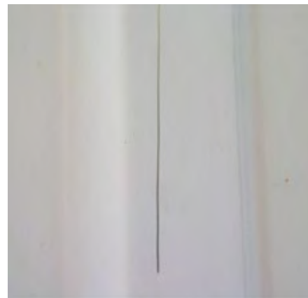
Ritsprov som visar bra vidhäftning på tidigare behandlat underlag.
