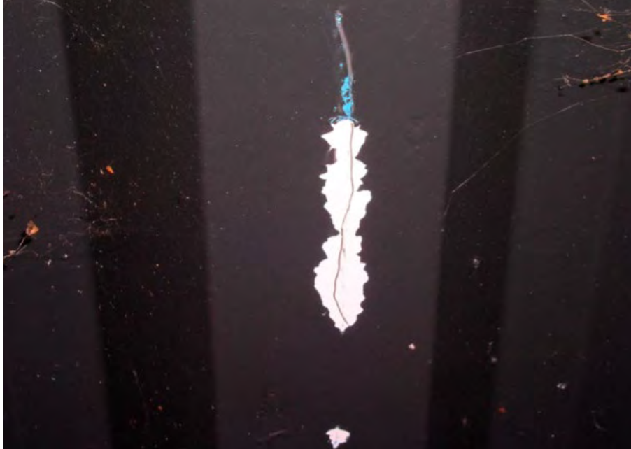
Ritsprov som visar dålig vidhäftning på tidigare behandlat underlag.
