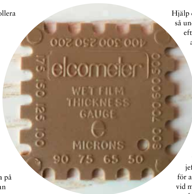
Våtfilmskam mäter man enkelt den våta färgfilmen med för att se att man lägger på tillräckligt med färg.
