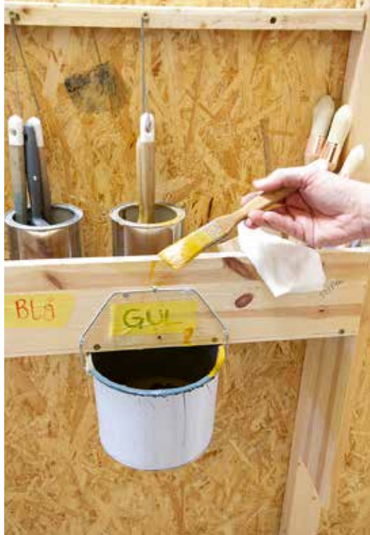
Smart upphängning av penslar och färgburk i fönsterverkstaden.
