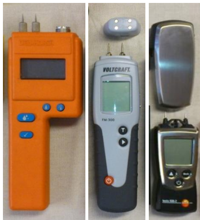
Figur 10 Rekommenderade mätare för ytfuktkvotmätning. Delmhorst J2000, Voltcraft FM-300 som också säljs i Sverige som Exotec MC-410 och EXTECH MO220 samt Testo 606-2
