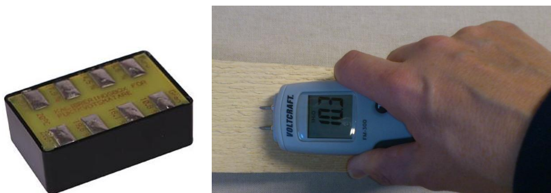
Figur 9 : Kalibreringsblock och princip för mätning på ytan
